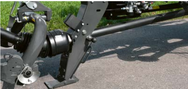
Halbautomatischer Stützfuß. Alle LINER Vierkreiselschwader verfügen über einen intelligent konstruierten halb-automatischen Stützfuß, der sich bequem mit nur einer Hand bedienen lässt.
