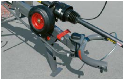
Die flexible Bügelanhangung mit Querpendelung ermöglicht Wendemanöver bis zu 80°.
