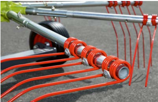
Werkzeuglose Abnahme der Zinkenträger.
