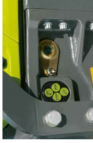
Mit elektronischen Steuergeräten können der Frontkraftheber und das zusätzliche Steuergerät auch extern bedient werden.
