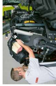
Der Motorluftfilter ist vor den Kühlern eingebaut und lässt sich leicht reinigen.
