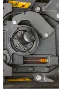
Den Ölstand von Getriebe und Hydraulik kontrollieren Sie über ein Schauglas neben der Zapfwelle.
