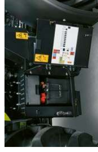
Rechts im Aufstieg finden Sie gut zugänglich die Batterie, das Werkzeugfach und einen Druckluftanschluss.
