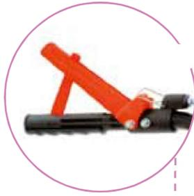
“GEARSTOP” n’arrête pas le moteur mais il bloque la transmission et la prise de force, en cas de relâchement de la poignée des mancherons.
