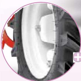
+ La largeur extérieure des roues et de la voie sont réglables. Les réglages adaptent la machine aux cultures spécialisées.
