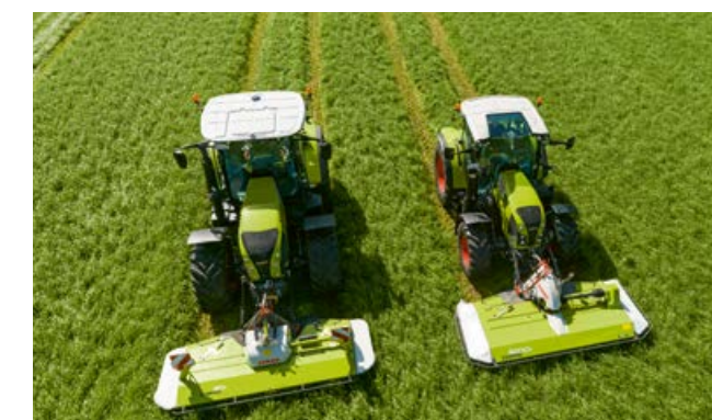
Schwadbreite mit einem oder zwei Schwadscheibenpaaren.
