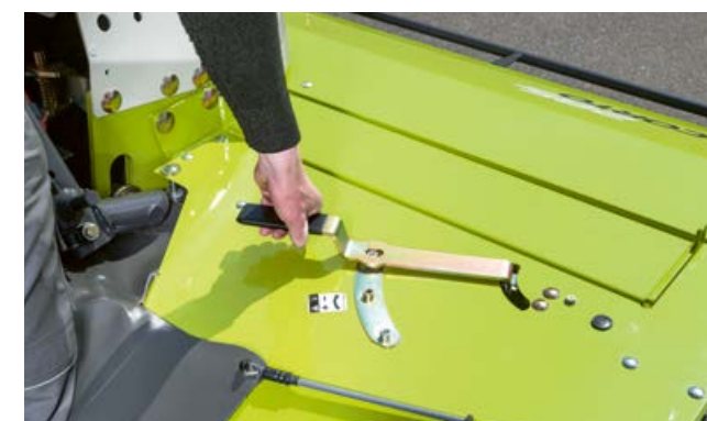
Schwadscheibenverstellung mit einem Handgriff.
