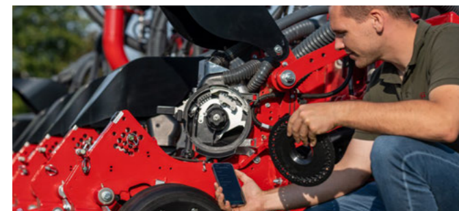
Die App HORSCH Assist mit der Funktion „Dosierscheibenwahl“ unterstützt bei der Auswahl der optimalen Dosierscheibe für jeden Einsatzzweck
