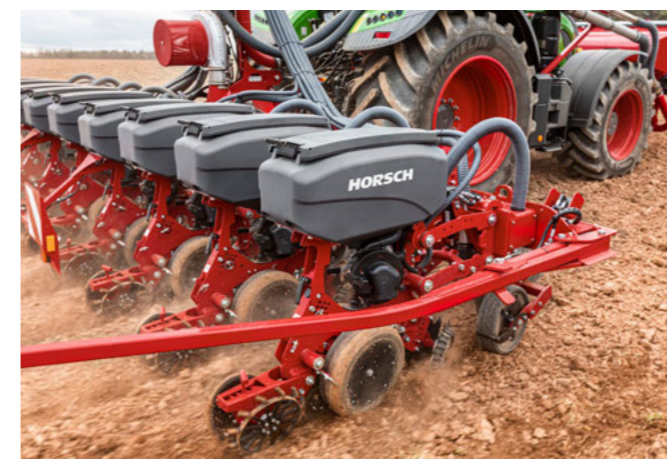
Hydraulische Schardruckanpassung für kompromisslose Einbettung
