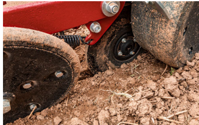
Die Fangrolle ist entscheidend für einen guten Korn-Bodenkontakt
