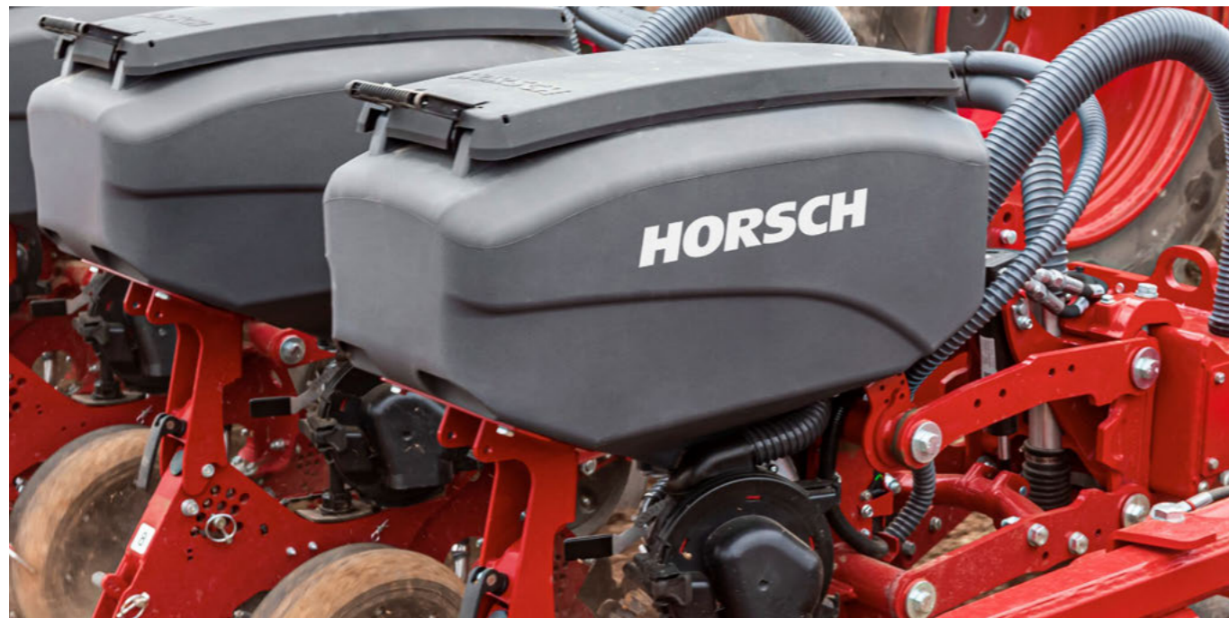
Reihenbehälter mit 70 l Volumen
