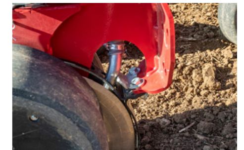
Pneumatische Applikation IN die Reihe
