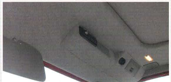
Vorbereitung für Radioeinbau
