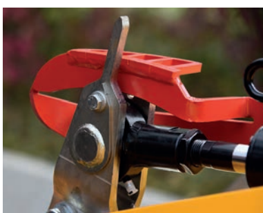
Die verstellbare hydraulische Schneidschiene Vario-Shift ermöglicht eine schnelle stufenlose Anpassung des Zerfaserungs- und Zerkleinerungsgrades an die jeweiligen Anforderungen direkt aus der Fahrerkabine (optional verfügbar für MU-PRO Vario 280).
