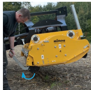
Einfaches Verstellen der Schwenk-Stützwalze, auch ohne zusätzliche Helfer.
