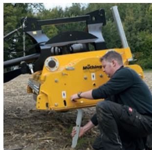
Einfaches Verstellen der Schwenk-Stützwalze, auch ohne zusätzliche Helfer.
