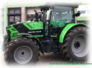
Motorenbremse, ASB, Power Beyond, Agrosky Vorbereitung, 2 Leiter DL EU Duomatic, Hydr. 1Leiter ,Isobus Vorbereitung, Load-Sensing Pumpe 120L, KF, GVA, FH, FZ, I-Monitor, 2 DW elektr., 1 DW vorne 2 DW mechanisch, Bereifung 540/65R24 und 600/65R38. Leergewicht 5215 kg
