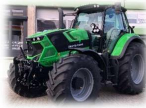
54V/27R-Gänge, Kriechgang, 6 Lastschaltstufen, Vorderachsfeederung, Motorbremse, 120 L Pumpe, Power Beyond 4 DW-Steuengeräte mit Schwimmstellung, 1Leiter Ölremse, 2Leiter DL EU + Duomatic, Kugel K 80, Stoll FL FZ 60.1, Isobus, FH/FZ, GVA, KF 600/60R28 und 710/60R38. Leergewicht 7000 kg
