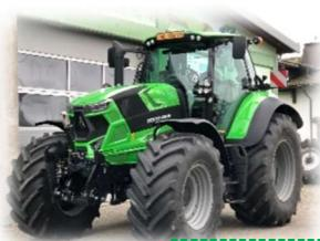
Sitzheizung, Aussenspiegel beheizbar, Klima, Agrosky Vorb., Frontkraftheber, Loadsensing 160 l/min., Komfortpaket für FHK. Power-Beyond, gebremste VA, ASM 100% Sperrdiff., Kabinenfederung, ISOBUS Vorbereitung, iMonitor 3, AHK K 80 Sauermann, 4 DW elektr., 2 DW vorne 600/70R30 und 710/70R 38, Leergewicht 8720 kg
