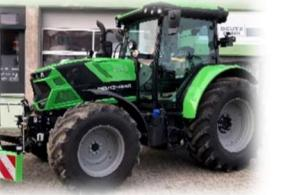
60V+60R Gänge, Powershift, 3 Lastschaltstufen, Power Beyond, 2Leiter DL EU, Hydr. AHB 1Leiter, ISOBUS-Vorbereitung, Load-Sensing Pumpe 120L, Klima, FH, FZ, 2 DW mechanisch, 1 DW elektr., 1 DW vorne, 480/65R24 und 600/65R34. Leergewicht 4880 kg
