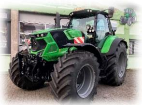
54V + 27R Gänge, Wendegetriebe, Kriechgang, 6 Lastschaltstufen, Motorenbremse, GVA, KF, 1Leiter-Ölbremse, DL EU/CH, FH + 1 DW vorne, Klima, 4DW mech. Hinten, Klima 160 Ltr. Pumpe, Power Beyond, Agrosky Vorbereitung, ISOBUS, gebr. Achse vorne, 600/60R30 und 710/60R42. Leergewicht 8200 kg
