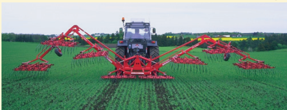
12 m Modell: das hydr. Klappsysteem im Feld.
