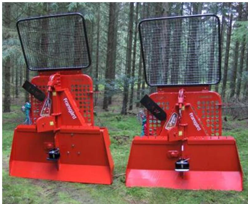
Une conception unique dans les moindres détails construite en acier robuste. Bouclier large et solide, poulie inférieure et support de hache équipés en série pour tous les modèles. Un support pour une scie tronconneuse et un crochet d'attelage sont disponibles en option.
