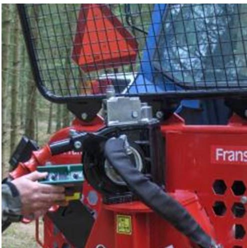
W-6011-EH sur demande avec déroulement hydraulique du câble (No d'article 1550) – pour une manipulation facile du câble.
