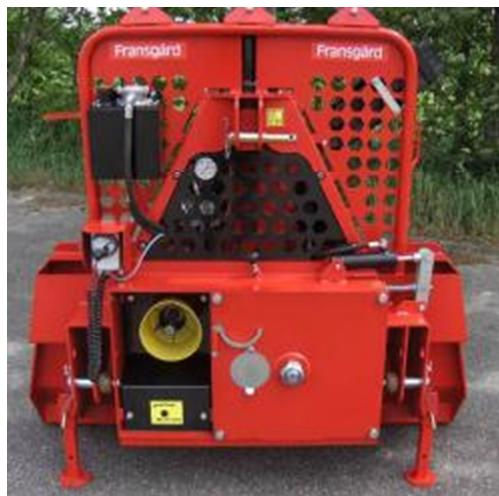
Modèle EH : hydraulique entraîné par la prise de force de l'embrayage et du frein, commandés par radio ou par câble.
