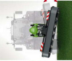
Angle d'oscillation transversale de +/- 13°
