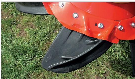
Höhe des Tastrades stufenlos verstellbar mit Gummi oder Stahlrad lieferbar
