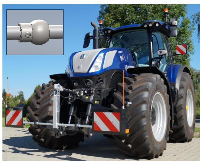
\*\* Aufnahme über 3-Punkt -> Oberlenker und Unterlenker-Fanghaken. Bei dieser Option ist eine parallele Nutzung des Oberlenkers und der Unterlenker nicht möglich. Proflektor für Kat. 2 / Kat. 3 L Fanghaken erhältlich. (Ober-/Unterlenker nicht im Lieferumfang enthalten)
