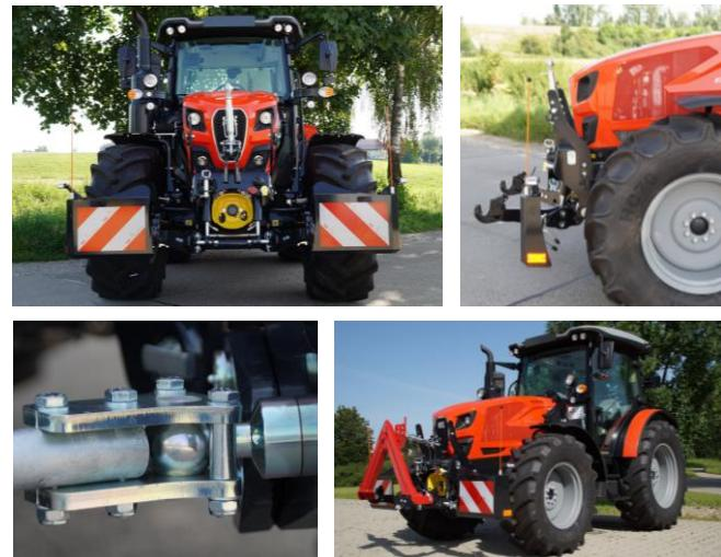
\* Bearbeitung vor Ort notwendig (Bohren der Befestigungslöcher an Unterlenker, Frontkonsole, o.ä.). Abstandsmaße sind bei dieser Option selbständig zu beachten. Bei Befestigung am Unterlenker können diese nicht ohne Demontage des Proflektors hochgeklappt werden.
