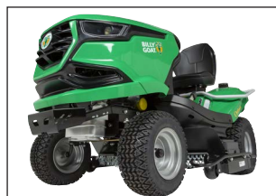
Pneu à gazon AV: 16x6.50-8, AR: 20x10.00-8
